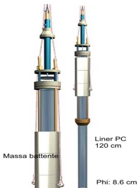
Fig.3.1.1-1: Carotiere leggero a gravità UWITEC con massa battente in alluminio.
