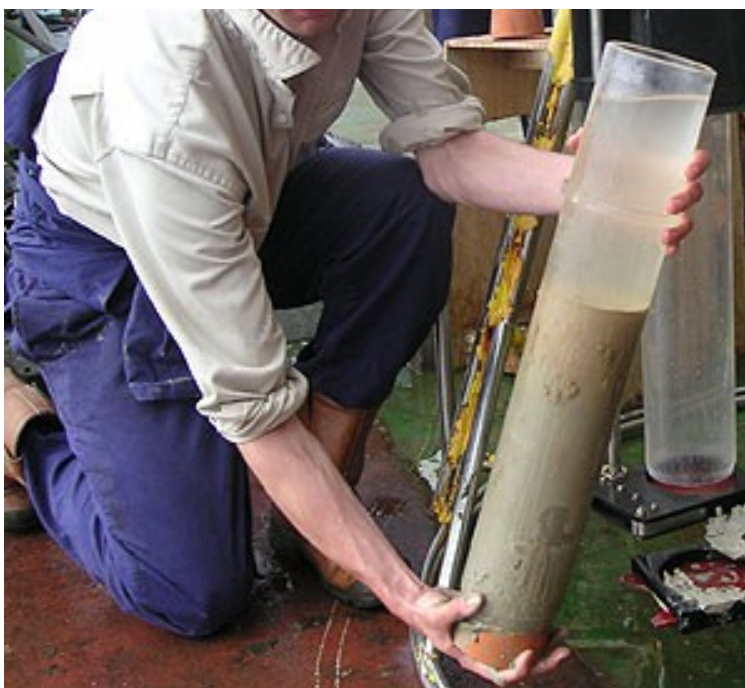
Fig. 3-2 Campionamento dei sedimenti marini mediante carotiere
